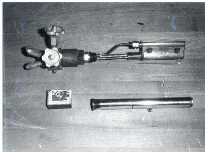
**Рис. 1.** Общий вид экспериментальной установки, выполненной в виде огнеструйной горелки ракетного типа, работающей на автоматизированной поточной линии (без операторов). Камера сгорания и сверхзвуковое сопло охлаждаются капиллярно-пористой системой.
