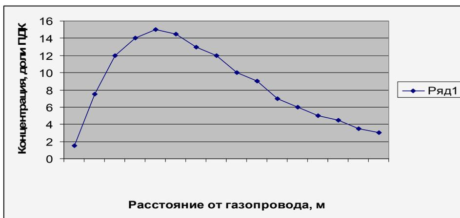
**Рис.1.** Зависимость изменения концентрации метана по мере удаления от источника выброса
